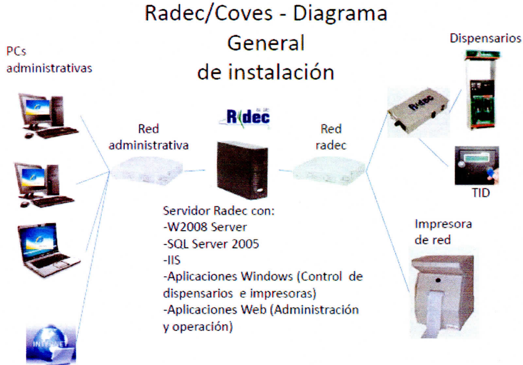
Figura 9. Diagrama general de instalación del sistema RADEC/COVES.
