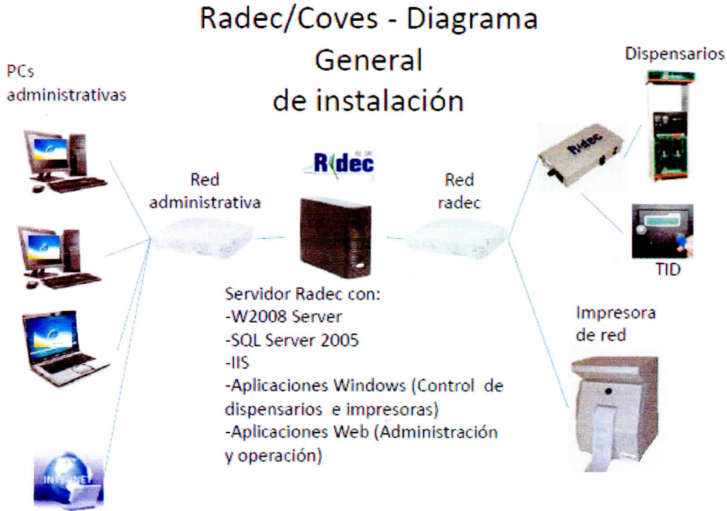
Figura 9. Diagrama general de instalación del sistema RADEC/COVES.
