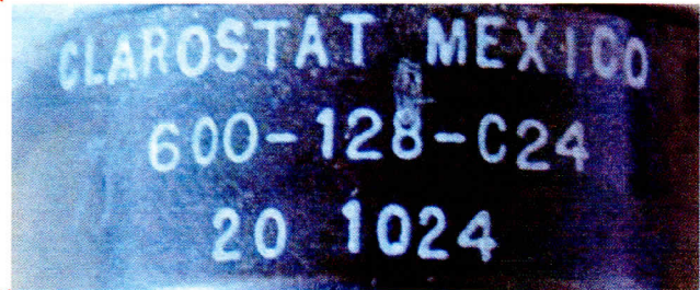
Figura 76. PULSER identificado con número de parte 600-128-C24 marca CLAROSTAT.
