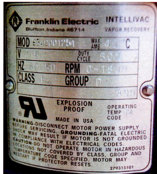
Figura 100. Vista detalle de la placa de la bomba de recuperación de vapores VP1000 Vacuum Pump.
