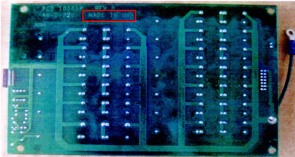
Figura 24. Tarjeta PULSER BARRIER identificada con número de parte 105660 revisión E , vista cara de soldaduras. Se detalla en rectángulo rojo el lugar de origen.
