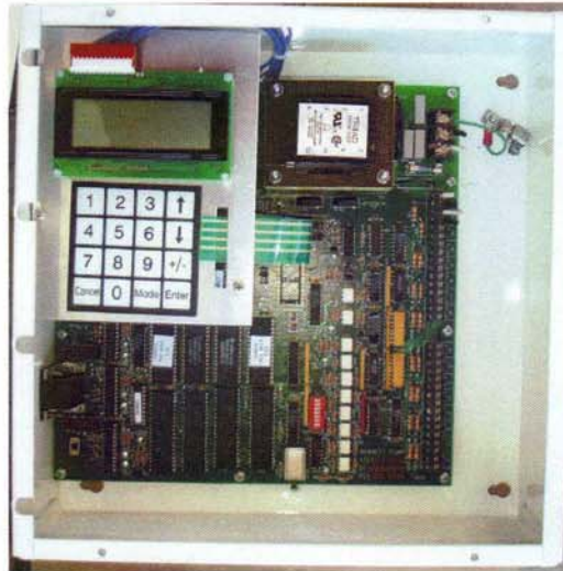
Interfaz 515 Interconnection Box de la marca Bennett
