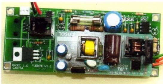
Módulo RADEC TID "Terminal de Identificación" identificado con número de parte **TID001**:
